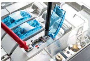
Test de tension direct sur fusibles HPC avec point de contact non isolé possible en soulevant le couvercle de protection sur poignée
