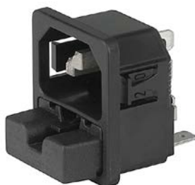
IEC Gerätestecker C14 mit Sicherungshalter 2-polig Schnappbefestigung von Frontseite Löt-/Steckanschlüsse Schnappbefestigung
